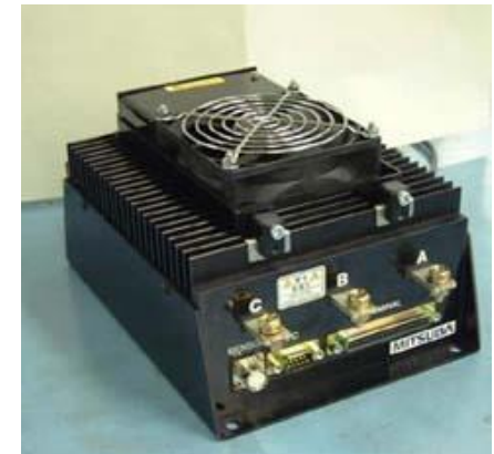
Kontroler za upravljanje elektromotora
