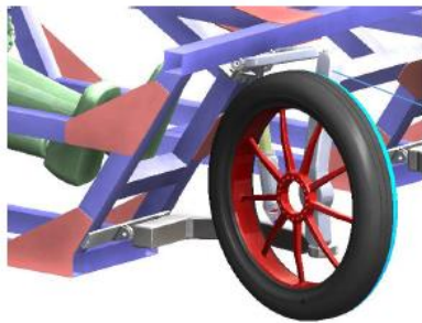
Prednji ovjes Duple vilice sa rukavcem Materijal: Aluminij 7075 T6
